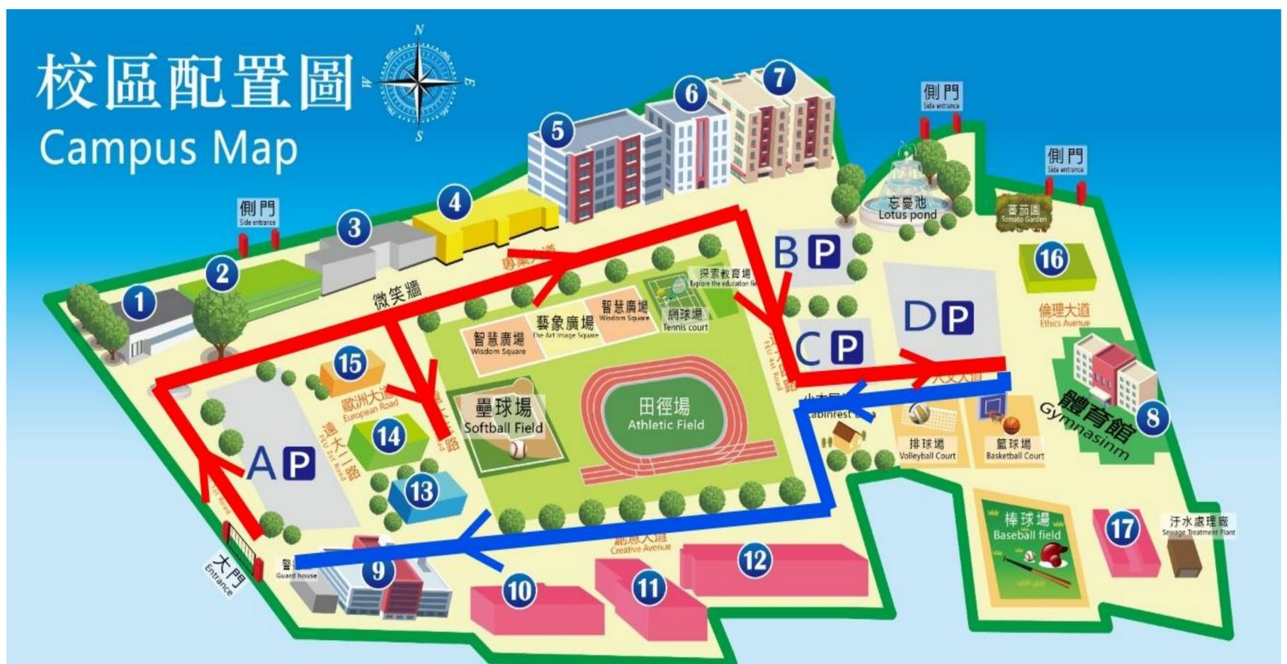
11/13 從紅色動線先做路面切割，再做藍色動線切割，切割期間出入口管制維持原狀。
